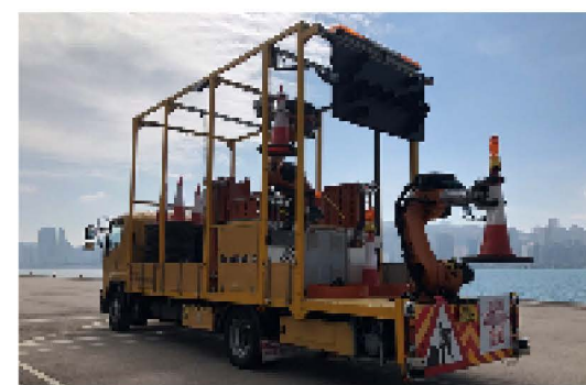
組裝在工程車上的智能機械臂系統 Full scale model — Roadbot 2
